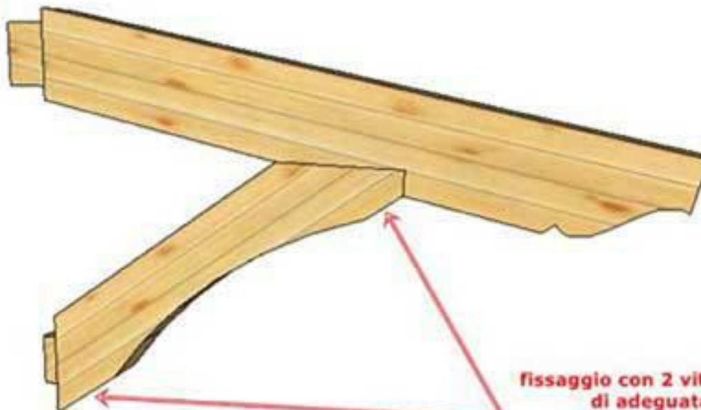
fissaggio con 2 viti per ogni incastro di adeguata lunghezza
