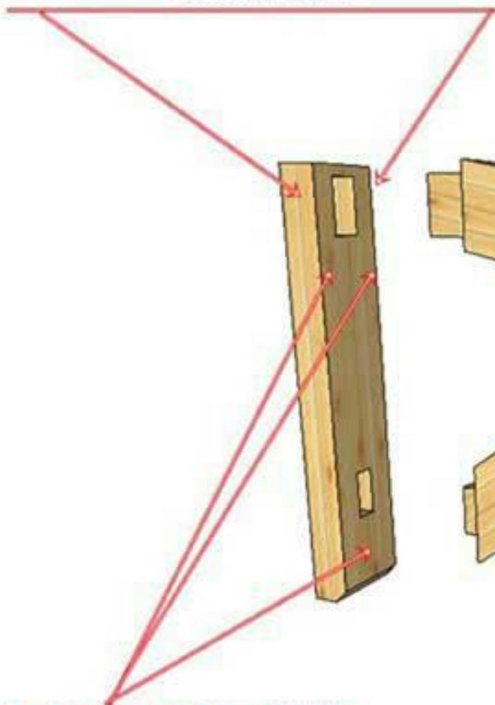
fissaggio al muro con n. 3 barre filettate con fissaggio chimico (resina minimo vinilestere)
